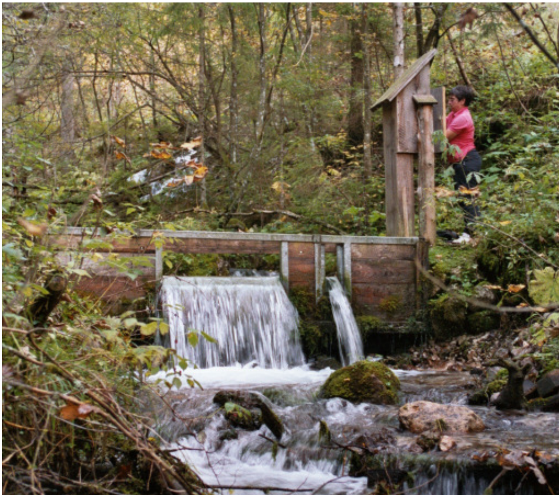
Abbildung 2: Messwehr Schwabeltalquelle (Steiermark)
