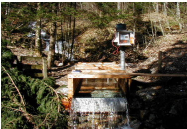
Abbildung 4: Messgerinne zur Erfassung des Wasserstandes
