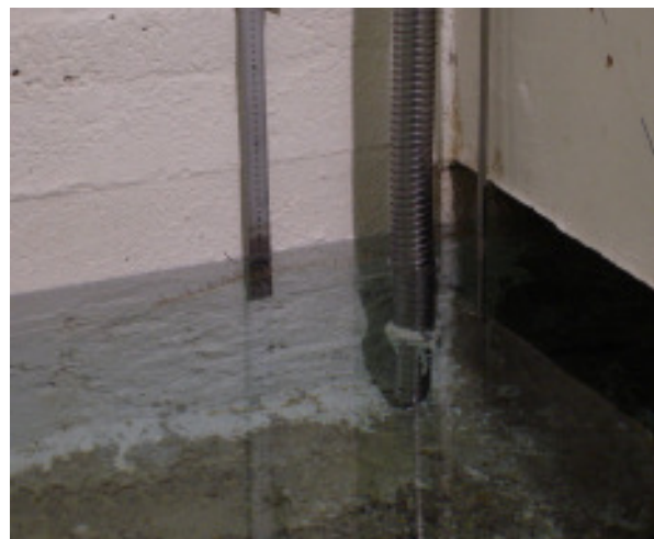
Abbildung 5: Lattenpegel und Leitfähigkeitssonde
